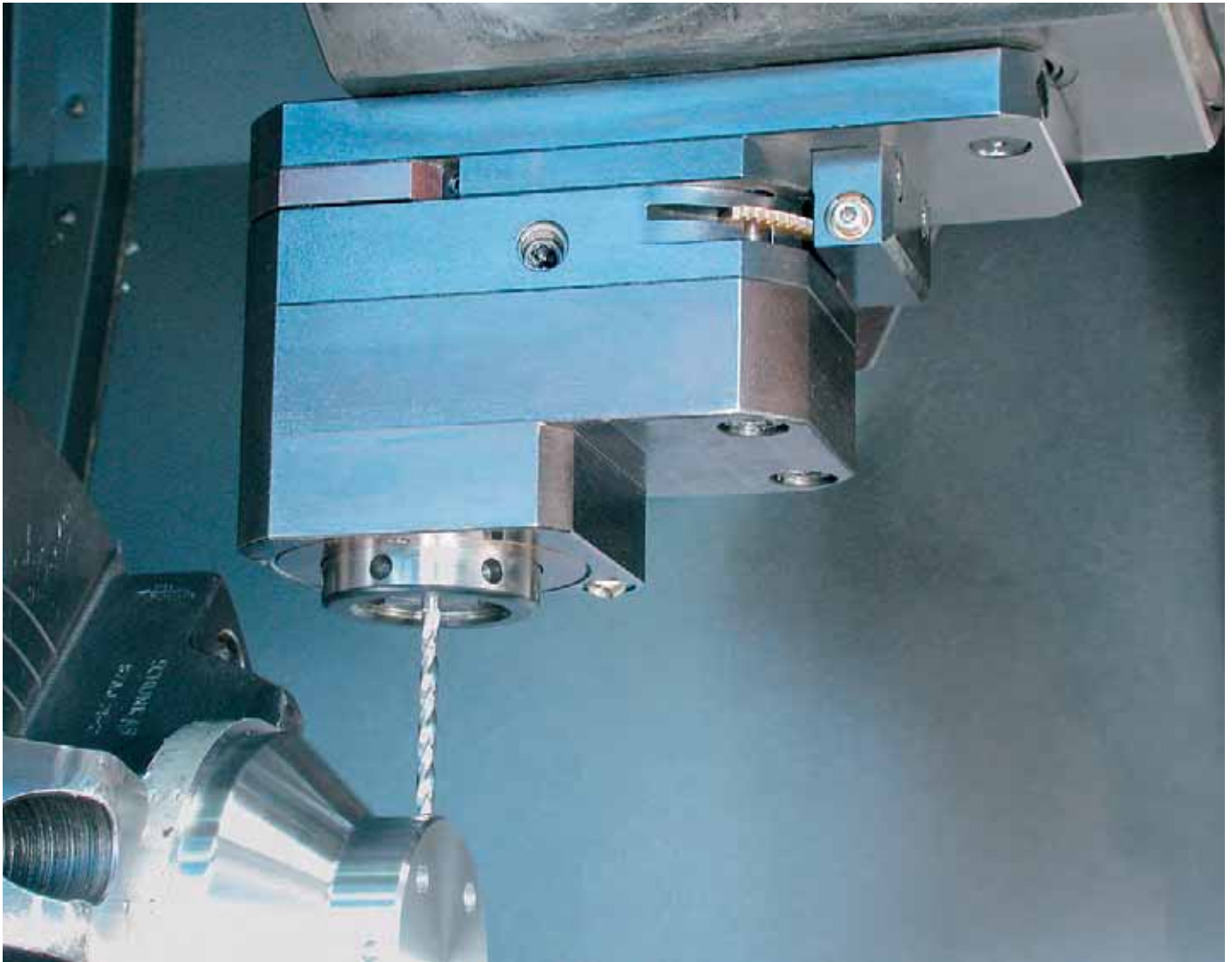
На иллюстрации изображен блок со смещением по оси Y с приводным шпинделем и бесступенчатой регулировкой \pm 50 мм по оси Y.
