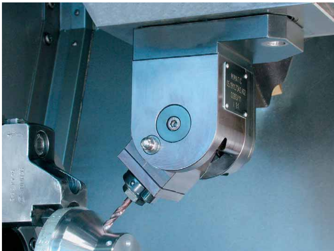
На иллюстрации изображена угловая головка с бесступенчатой регулировкой (90°) на станке Mazak SQT 18 MS с обрабатываемыми отверстиями с диаметром 45.
