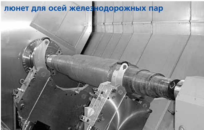
люнет на резцовой головке
