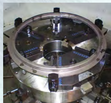
InoZet ®-Sonder- 12-Punktspannung InoZet ® special solution
